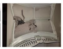
**Další filtr je ve spodní části sušičky**, otevřou se dvířka a otočí se dle šipek. **Another filter is located in the lower part of the dryer**. Open the door and turn in the direction of arrows.
